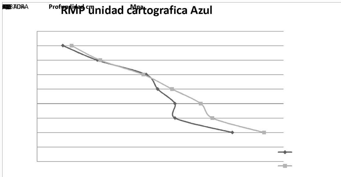
**Figura 4.** RMP Resistencia mecánica a la penetración medida en mega pascuales (Mpa) hasta la profundidad de 40cm con intervalos de medición de 5cm. Para la unidad cartográfica Azul ubicado en cercanías de la ciudad de Necochea ( $38^{\circ}30'18.68''S$ ;  $58^{\circ}52'40.58''O$ ) Comparando dos situaciones contrastantes de suelo. Letras diferentes indican diferencias significativas  $P < 0,05$ .
