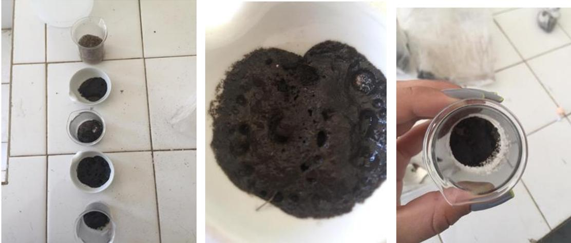
Análisis del contenido de materia orgánica mediante el método de burbujeo.
