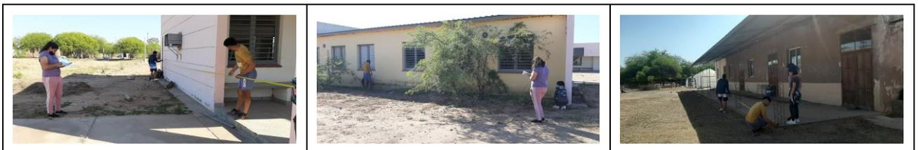
Figura 2. Mediciones en la EET para el cálculo del área de captación del agua de lluvia.
