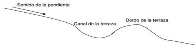
Una vez que el agua llega al canal de la terraza debe ser evacuada del potrero, por eso las terrazas tienen una pendiente interna de alrededor del 0,5 %. Esta pendiente evita que el agua se acumule en el canal y sobrepase el bordo. La pendiente del canal no puede ser mucho mayor al 0,5% para evitar que se produzca erosión en su interior.
