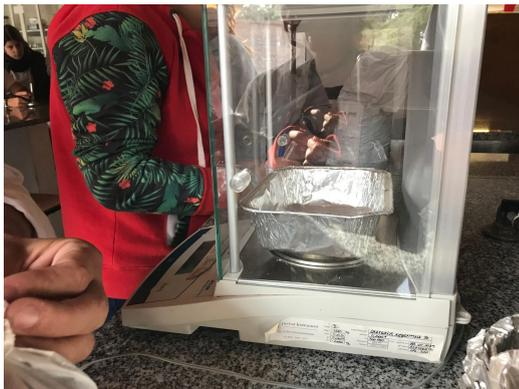
fig.8. Muestra húmeda siendo pesada en la balanza analítica
