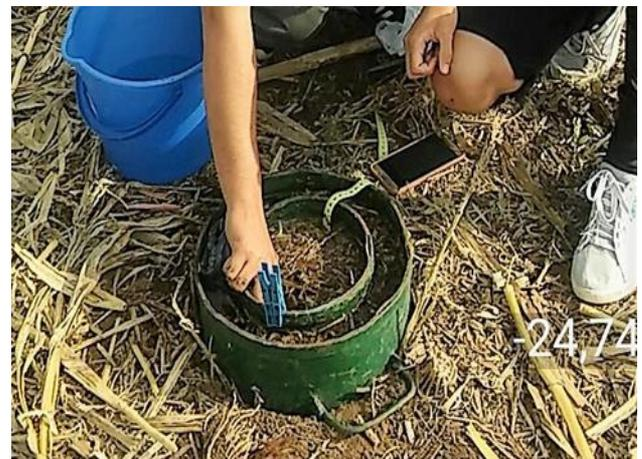
Foto 4: Infiltrómetro de doble anillo en lote agrícola.
