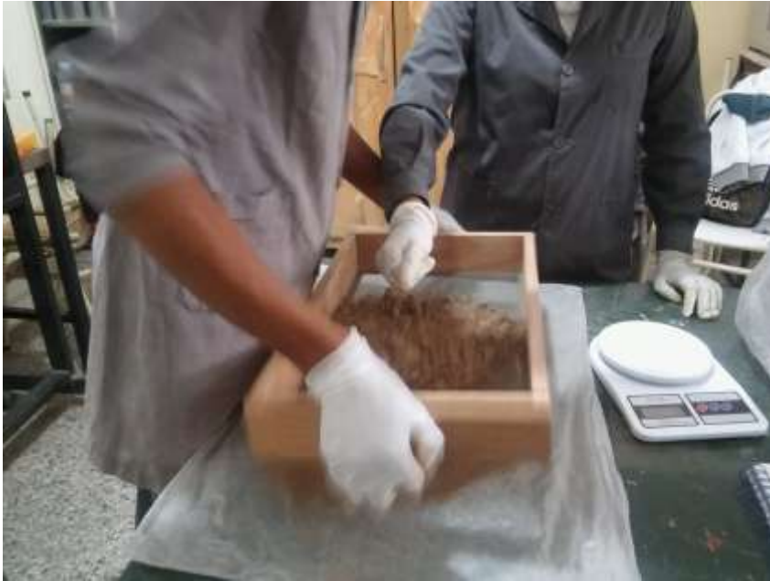
Foto 3: Tamizado de muestras previo secado en horno a 105°C
