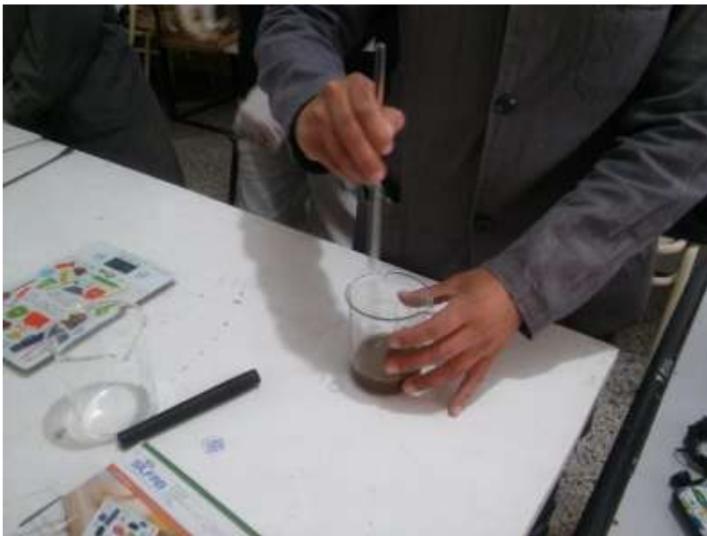
Foto 4: Homogeneizado de las muestras de suelos 1:2,5 para determinar pH
