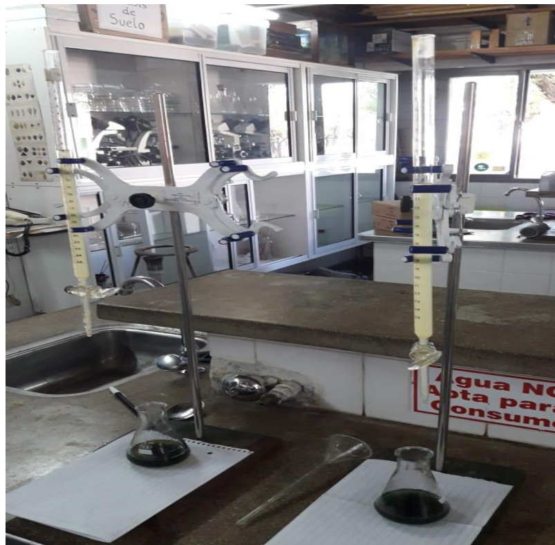
Figura n° 3: Determinación de materia orgánica por titulación con sal de Mhor 0,5 mol/l.
