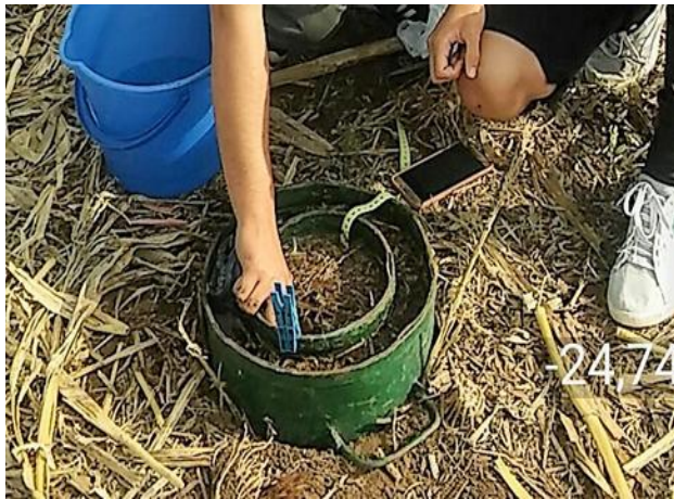
Foto: Infiltrómetro de doble anillo.
